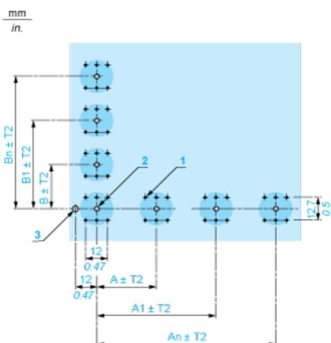
A 24 mm (0.94 po.) minimum pour têtes rectangulaires ; 18 mm (0.71 po.) minimum pour têtes carrées ou circulaires
