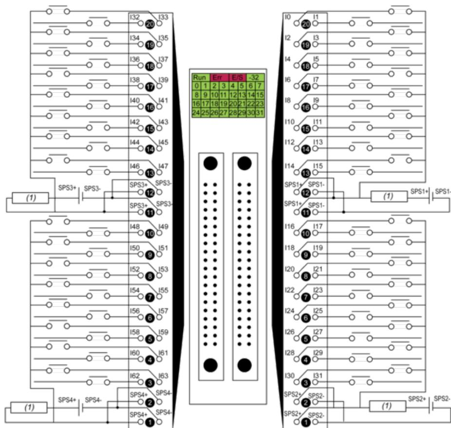
(1) Fusibile: fusibile ad azione veloce da 0,5 A per ogni gruppo di 16 canali
