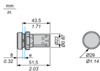
e Spessore pannello di supporto: da 1 a 6 mm/da 0.4 a 0.24 in. (metallo), da 2 a 6 mm/da 0.8 a 0.24 in. (plastica).
