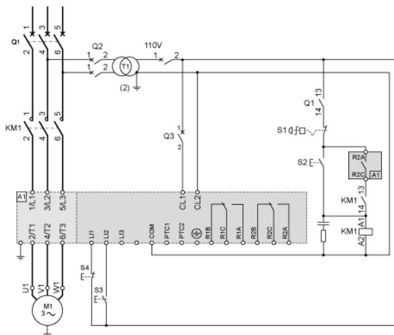
110-VAC-Steuerung, Logikeingänge (LI) 110 VAC, 2-Draht-Steuerung, freier Auslauf
