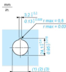
(1) Durchmesser auf fertiger Schalttafel oder Montagehalterung
