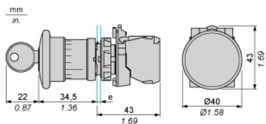
e : épaisseur du dispositif de serrage : 1 à 6 mm / 0,04 à 0,24 pouce
