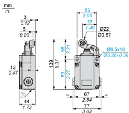
(1) 3 Gewindedurchführungen für Kabelverschraubung Pg 13.5
