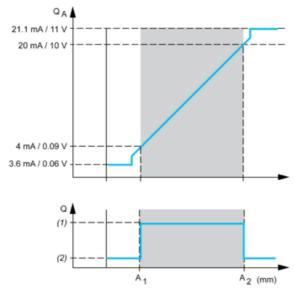
QA : Analogue output Q : Switching output
